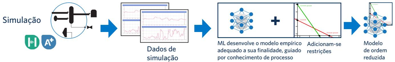
Figura 2: Fluxo de trabalho de modelo híbrido de ordem reduzida. Os engenheiros de processos empregam modelos de simulação calibradas para gerar modelos de ordem reduzida por Machine Learning que podem ser implantados consistentemente em um intervalo de aplicações necessárias
