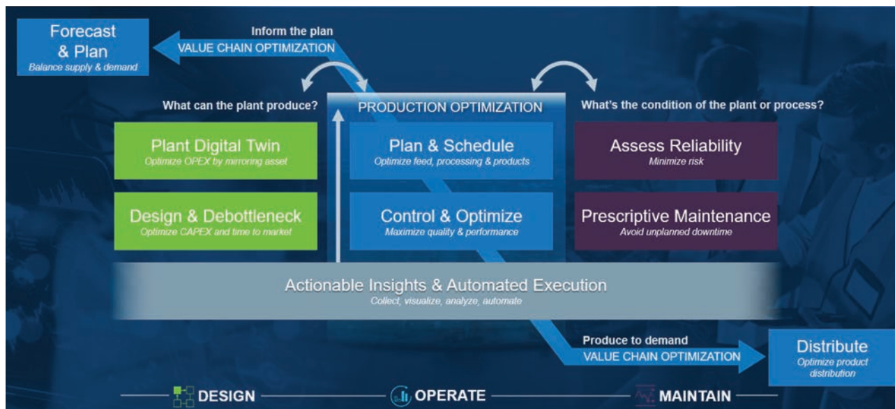
図2:アスペンテックの資産最適化デジタルリファレンスアーキテクチャー (お客様およびアスペンテックのイノベーション研究開発向けの青写真)。このデジタルリファレンスアーキテクチャーはアスペンテックの広範なデジタルツインソリューションと連携しています(4ページの図)。上図の左側のボックスはプラントデジタルツイン、中央のボックスはオペレーショナル エクセレンス デジタルツイン、右のボックスはオペレーショナル インテグリティ デジタルツインを表します。
